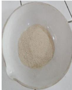
Gambar 6.9. Hasil *Bleaching* dengan Larutan  $H_2O_2$  10%
