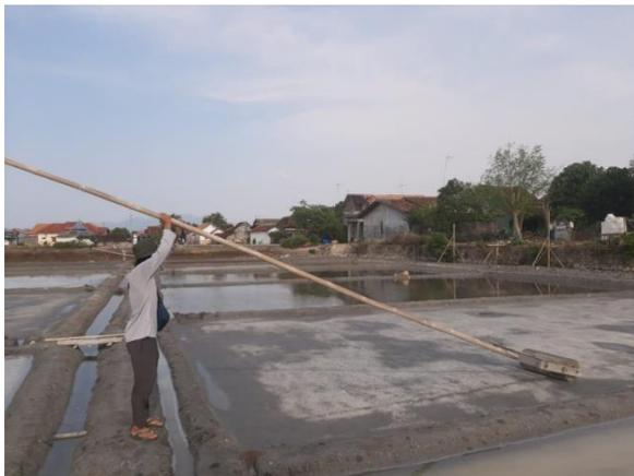
Gambar 4.3. Serokan Kayu Untuk Meratakan Air Agar Evaporasi Merata
