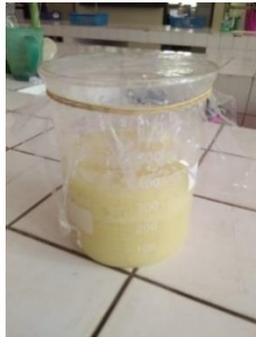
Gambar 6.7. Proses *Bleaching Crude* Selulosa dengan Larutan  $H_2O_2$  10% Selama 24 Jam
