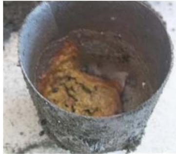
Gambar 2.4. *Fracture* pada *Crucible* karena Bereaksi dengan Logam yang Dileburkan (Ilias, 2018).
