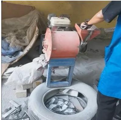
Gambar 2.10. Mesin *Crusher* untuk Limbah *Evaporation Boats*
