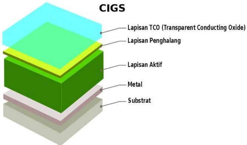
Gambar 3.2. Struktur Penyusun Panel Surya
