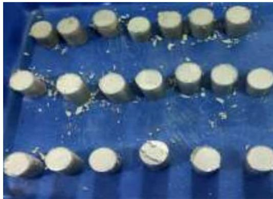
Gambar 2.16. Spesimen *Crucible* setelah Proses Kompaksi
