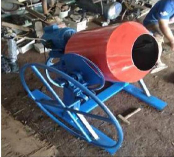
Gambar 8.9. Mesin *Mixer* untuk Mencampurkan Bahan Baku
