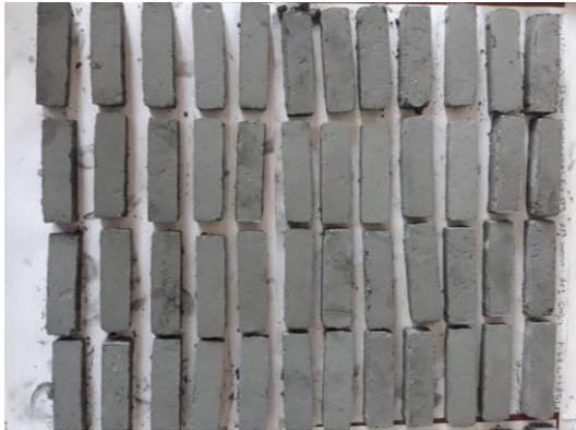
Gambar 8.11. Spesimen *Crucible* Setelah Proses Kompaksi
