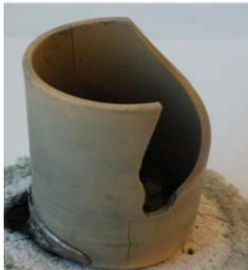
Gambar 2.3. *Fracture* pada *Crucible* Selama Proses *Cooling* (*Thermal Shock Resistance* yang Rendah) (Ilias, 2018)
