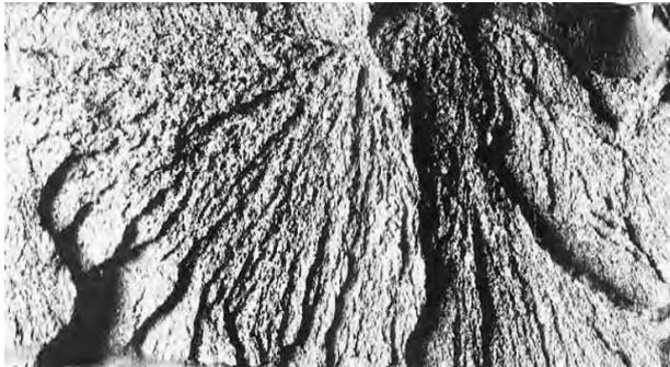
Gambar 8.22. Foto Permukaan pada *Brittle Fracture*
