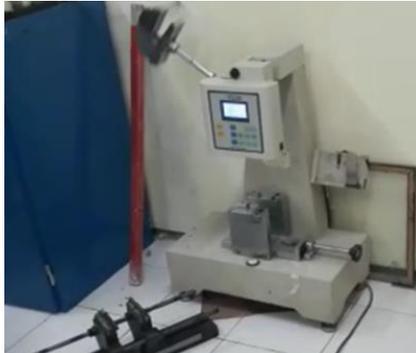
Gambar 8.14. Proses Uji *Impact* Menggunakan Alat Mesin *Impact Gotech*
