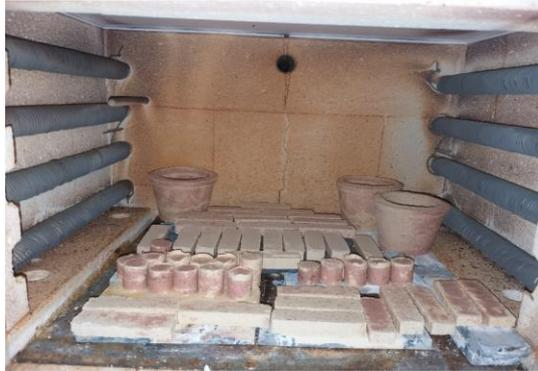
Gambar 8.12. Proses *Sintering* pada Spesimen *Crucible*
